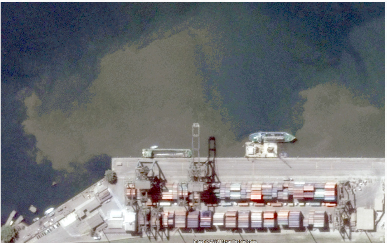
PLUMA DE TURBIDEZ DURANTE O TRABALHO DE DRAGAGEM MECÂNICA NO PORTO [8]
